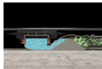
Bote con sifón invertido integrado
